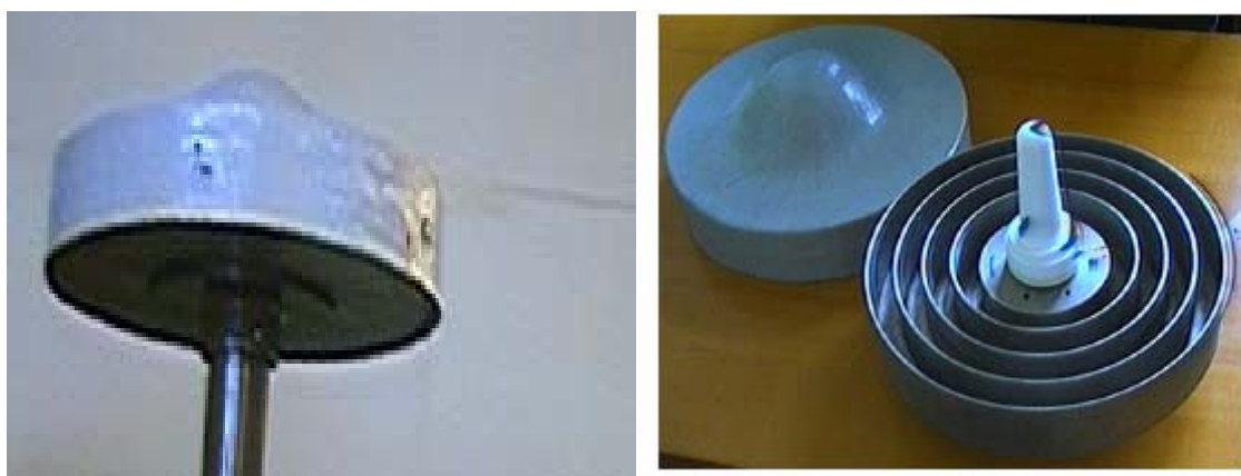
Рис. 5.5. Антенна со структурой подавления многолучевости
