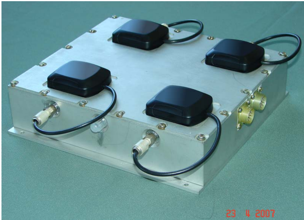
Рис. 7.54. Адаптивная к помехам антенная решетка
