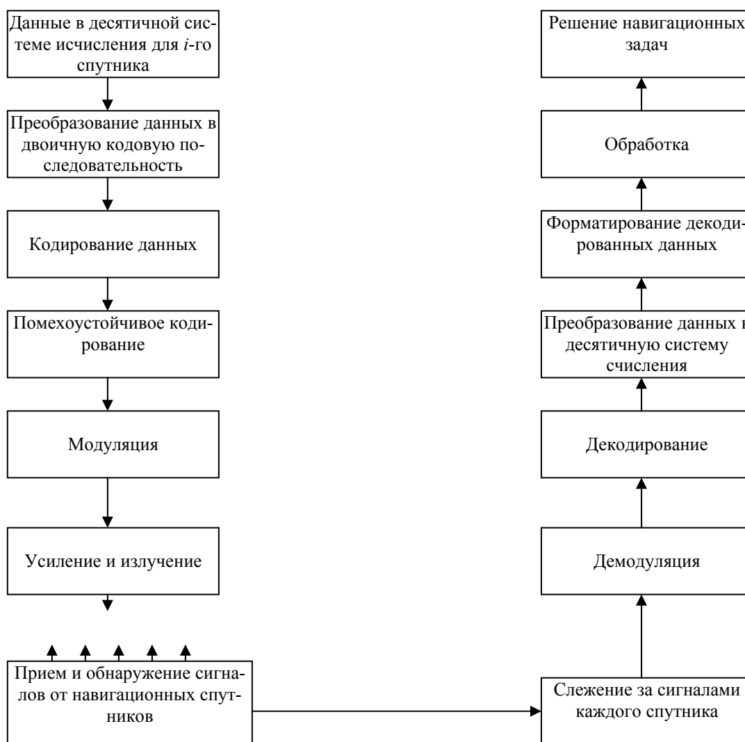
Рис. 4. 1. Схема формирования, передачи и приема сигналов СРНС
