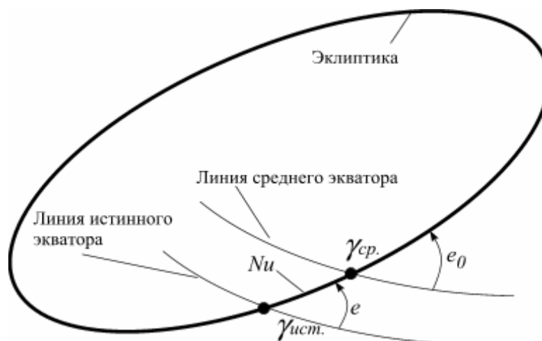
Рис. 3.14. Геометрическое толкование нутации
