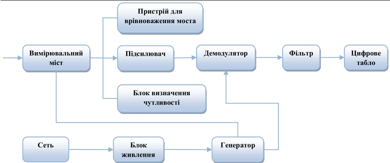
Рис. 2. Структурна схема каналу вимірювача деформації
