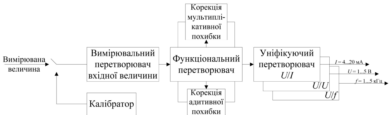
Рис. 3. Структурна схема аналогових інтерфейсів з ручною корекцією
