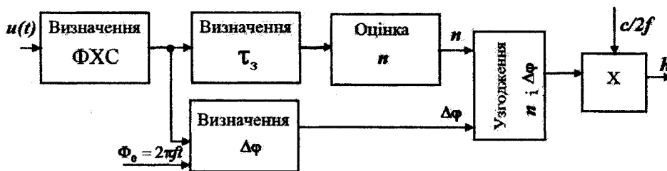
Рис. 1. Структурно-логічна схема двошкального методу ультразвукової лунаімпульсної товщинометрії
