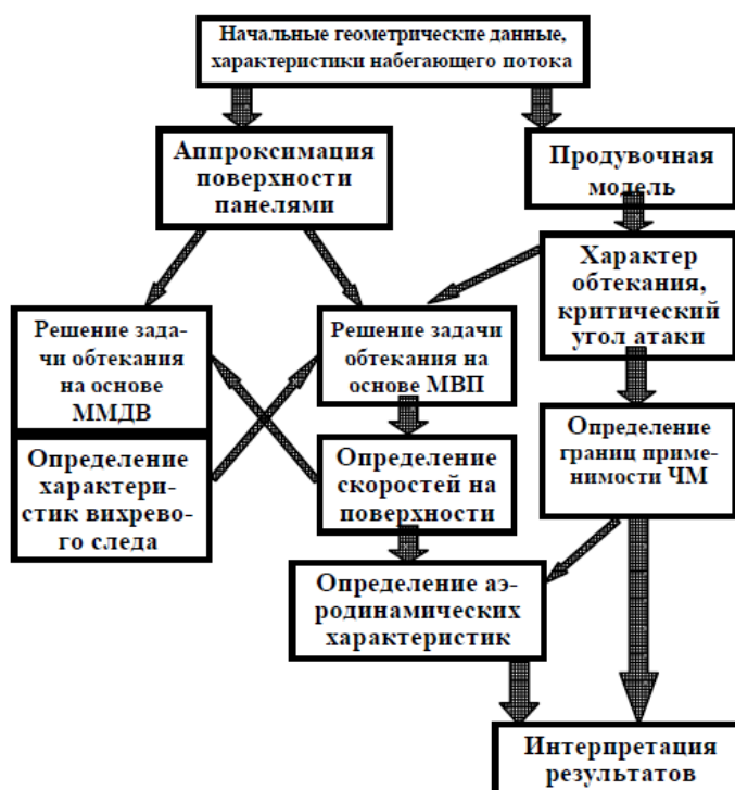
Рис. 1.8. Структурно-логическая схема комплексного метода определения аэродинамических характеристик сложных пространственных компоновок.
