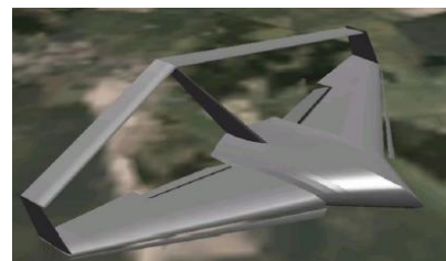
Рис. 1.3. Замкнутое крыло. Расположение полезной нагрузки [1].
