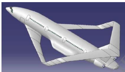
Рис. 1.3. Замкнутое крыло. Расположение полезной нагрузки [1].
