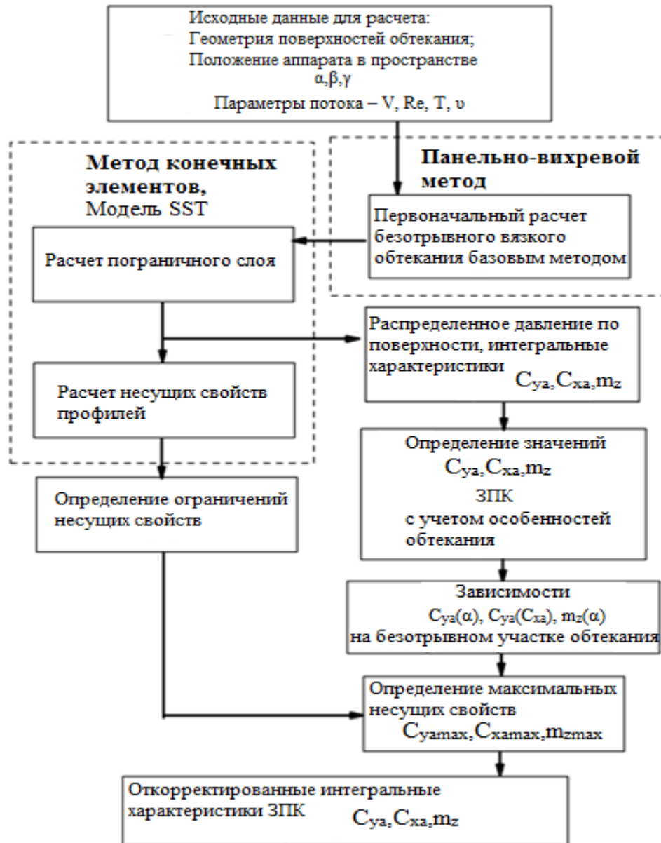
Рис. 4.29. Общие схема математического моделирования аэродинамических характеристик ЗПК.
