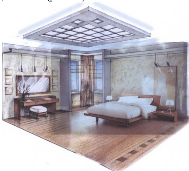
Рис. 7.12. Натяжна стеля на каркасі зі світильниками денного світла
