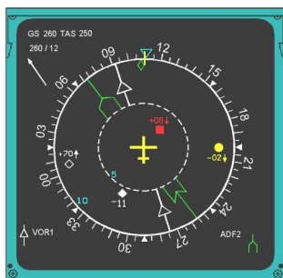
Рис. 6.5. Навігаційний індикатор електронної системи пілотажного обладнання в режимі «Роза» відтворює повітряний рух
