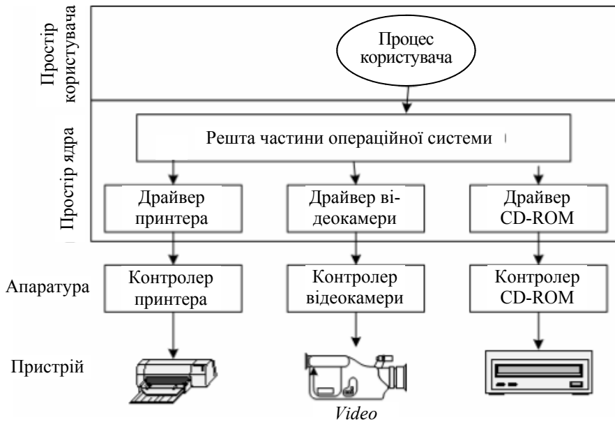
Рис. 2.37. Логічне розміщення драйверів пристроїв
