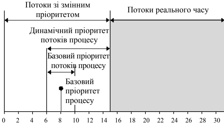
Рис. 2.7. Схема призначення пріоритетів у Windows NT
