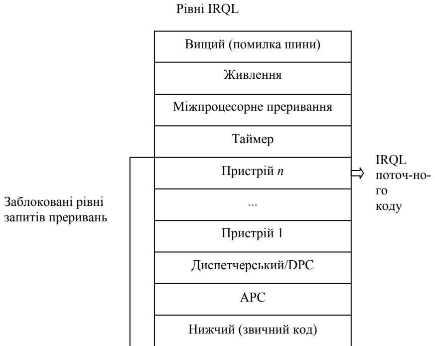
Рис. 2.11. Диспетчеризація переривань у Windows NT
