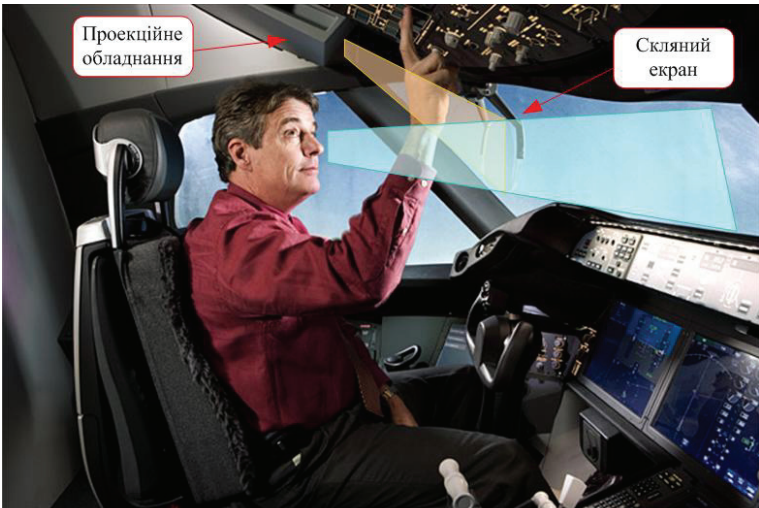
Рис. Д57. Принцип функціонування HUD В-787
