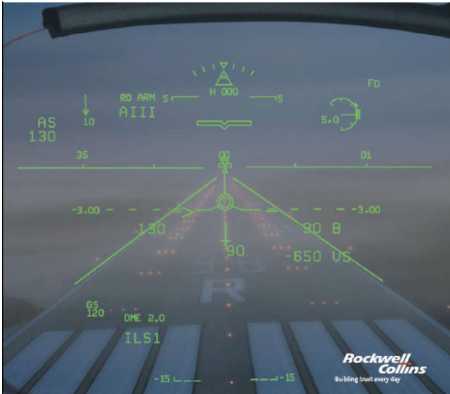
Рис. Д58. Відображення пілотажно-навігаційної інформації на етапі зльоту (HGS, RocwellColins)
