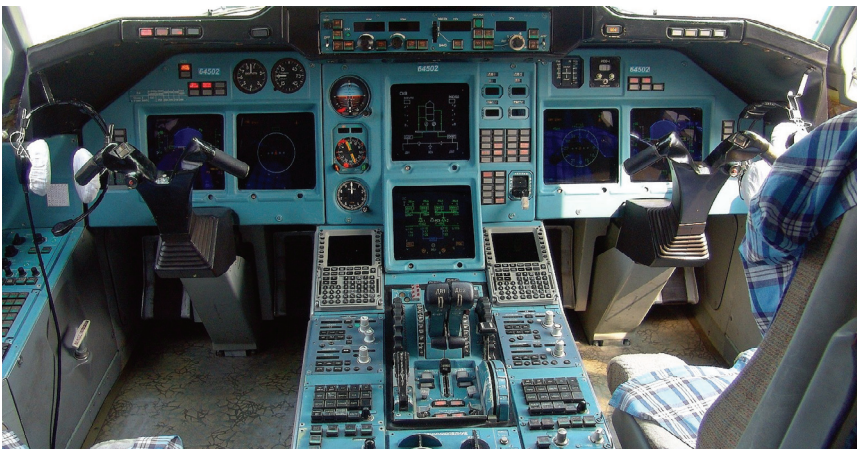
Рис. Д37. Розміщення MCDU у кабіні Ту-214
