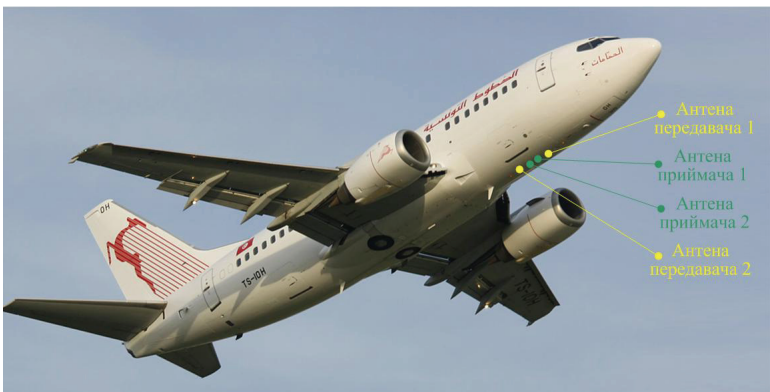
Рис. Д19. Розміщення антен RAL на B737
