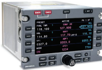
Рис. Д30. Пульта керування обладнанням зв'язку UASC [105]
