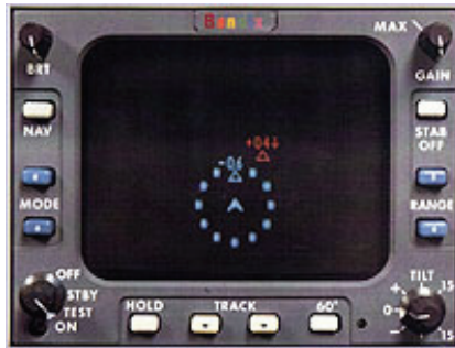
Рис. Д24. Відображення даних від TCAS на дисплеї метеорадіолокатора
