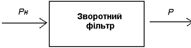
Рис.2. Схема відтворення початкової інформації P за низькочастотною складовою P_n .
