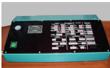
Рис. 1. Внешний вид блока индикации параметров ДВС
