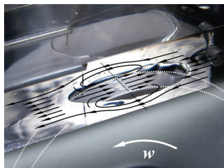
Рис. 2. Линии тока смазочной среды (а) и трибокавитация (б), наблюдаемые в динамике при трении на лабораторном приборе АСБ-01 с оптическим каналом съема информации
