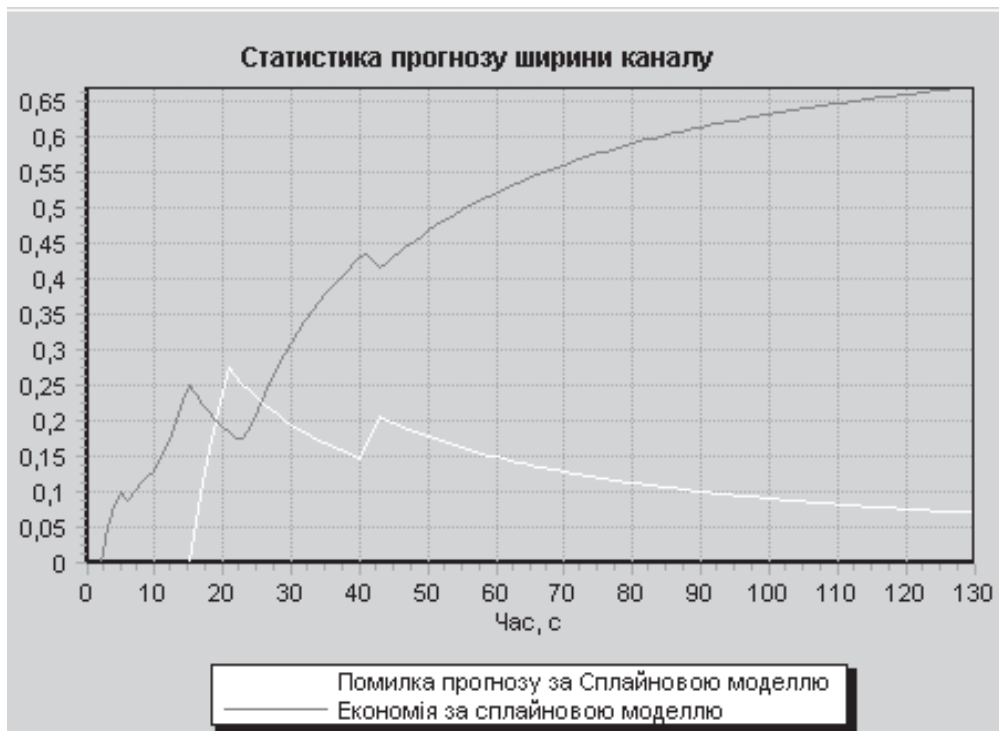
Рис. 4.10. Часові залежності параметра помилки та показника економії при обчисленнях за методом експоненціального згладжування
