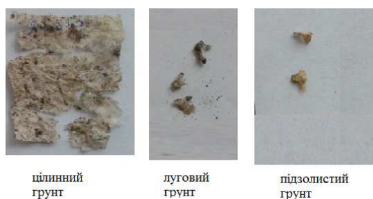
Рис. 4. Ступінь розкладу целюлозовмісних матеріалів (I-вата, II- фільтрувальний папір, III-серветка) в залежності від типу ґрунту (тривалість розкладу – 45 днів для матеріалів I та II, 30 днів для матеріалу III)
