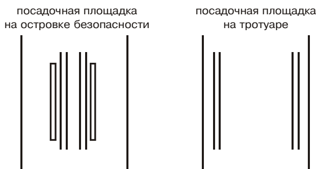
Рис. 3.18.1. Трамвайная посадочная площадка на островке безопасности и на тротуаре
