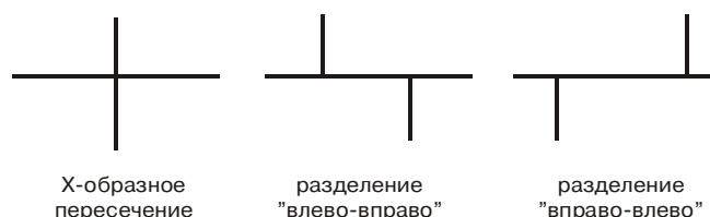
Рис. 1.8.1. Способы разделения одного X-образного пересечения на два T-образных
