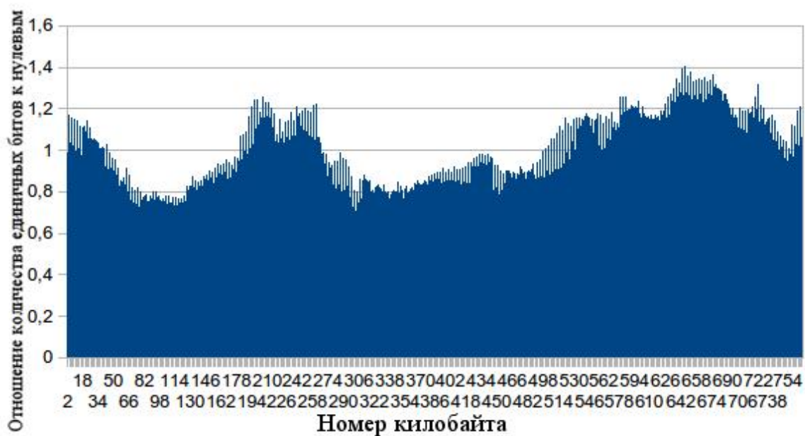
Рис. 2.2. Отношение между количеством нулевого и единичного бита для не кодированного изображения bmp
