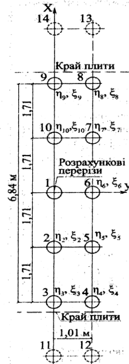
Рис. 2. Схема навантаження основної опори ПС Ан-225
