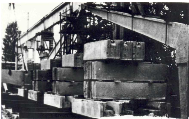
Рис. 14. Випробування рами завантаженням штучними вантажами
