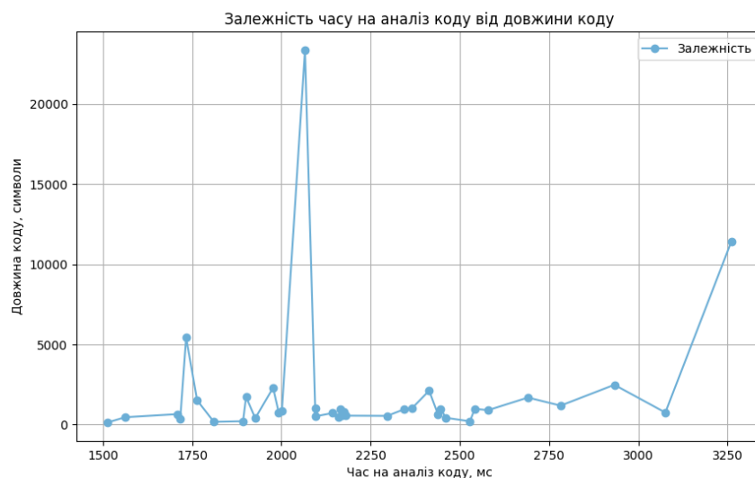
Рис. 4.11. Графік залежності часу на аналіз коду від його довжини
