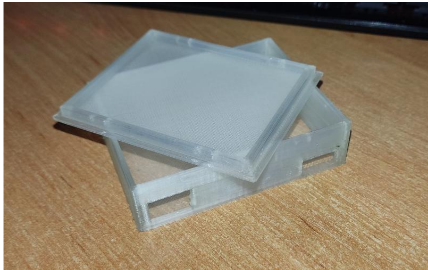
Рис. 3.1.12 Корпус після печаті на 3д принтері
