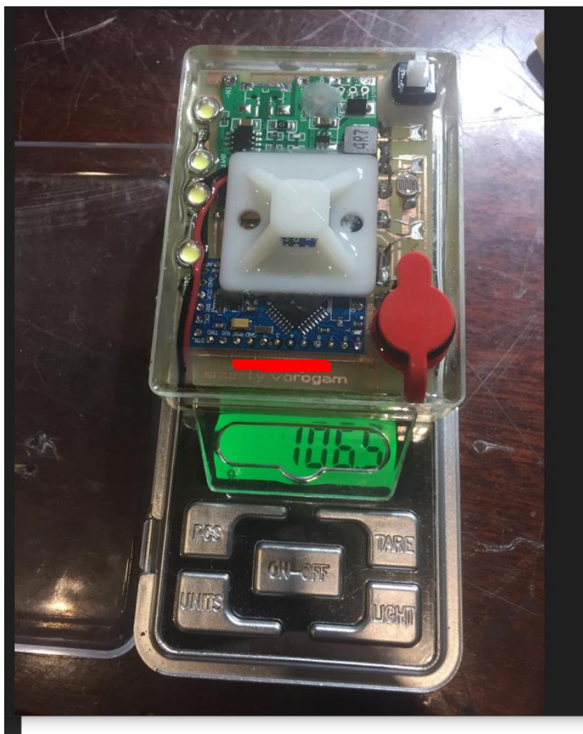
Рис 3.1.9 Модуль залитий в епоксидну смолу
