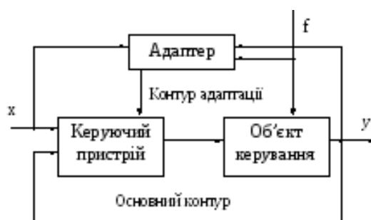
Рис. 1.1 – Функціональна схема адаптивної системи
