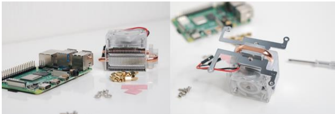
Рисунок 2.12 – Встановлення кулеру із радіатором на міні-ПК Raspberry Pi
