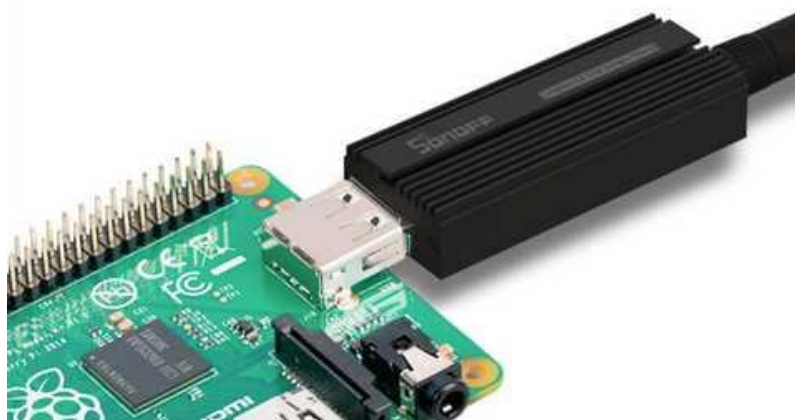
Рисунок 2.11 – Підключення ZigBee адаптеру до міні-ПК Raspberry Pi
