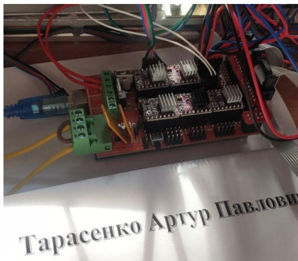
Рисунок 2.6. - Підключення крокового двигуна для пластика і екструдера
