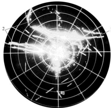
Рис. 1.11. Фото впливу пасивної перешкоди від дипольних відбивачів (ДВ): 1 – викид ДВ у безперервному режимі; 2 – викид ДВ у дискретному режимі
