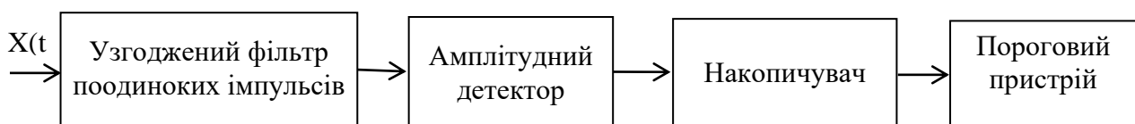
Рис. 2.8. Узагальнена схема оптимального приймача некогерентної пачки імпульсів
