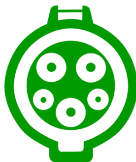
Рис. 2.6. Приклад схематичного зображення роз'єму ( Type 1 J1772 , США/Японія)
