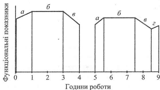
Рис. 3.3. Типова крива працездатності протягом робочої зміни: а — впрацювання; б — стійка працездатність; в — зниження працездатності; г — емоційний порив
