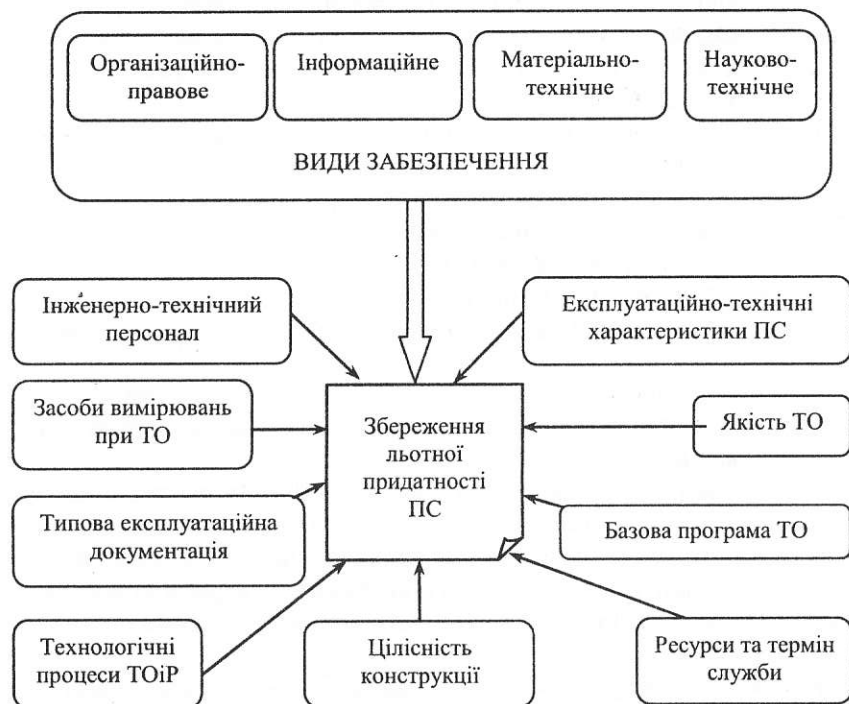
Рис. 6.1. Види забезпечення льотної придатності і фактори, які сприяють її збереженню під час експлуатації ПС
