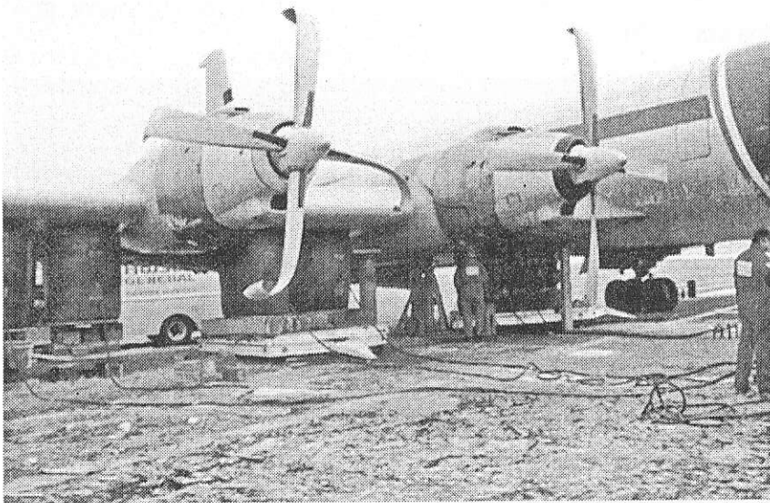
Рис. 1.7. Пошкодження гвинтів силової установки через відмову системи випуску шасі
