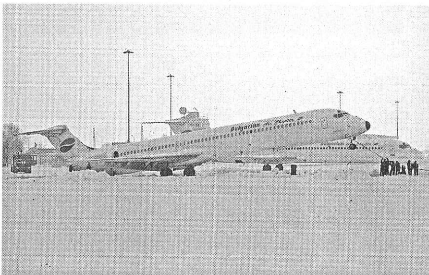
Рис. 1.11. Під час ТО не встановлено засобів запобігання перекиненню літака через зміну центрування ПС
