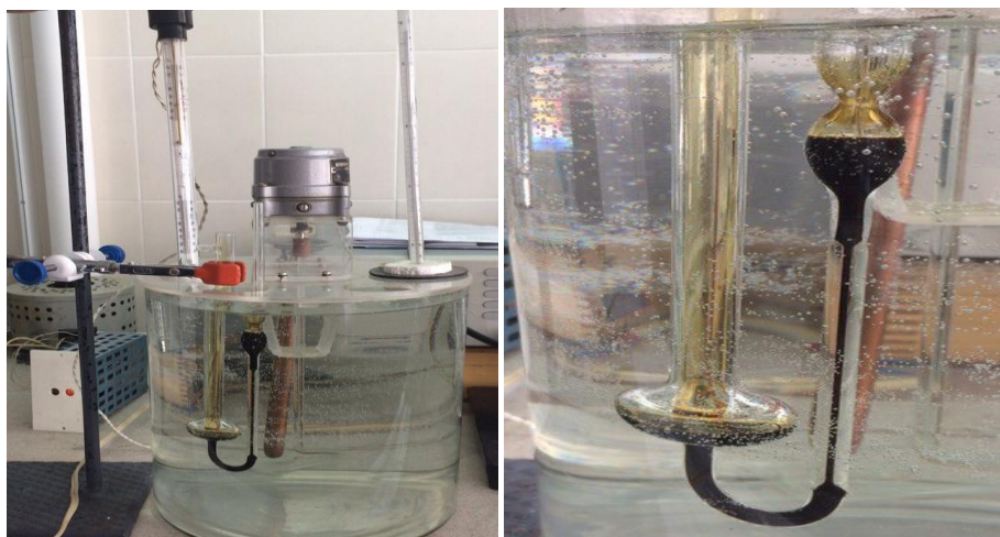
Рис. 1. Визначення в'язкості відпрацьованої оливи
