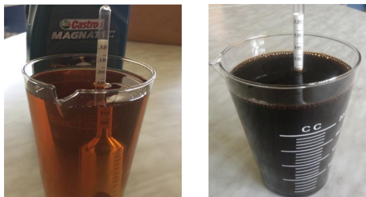
Рис. 2. Визначення густини оливи
