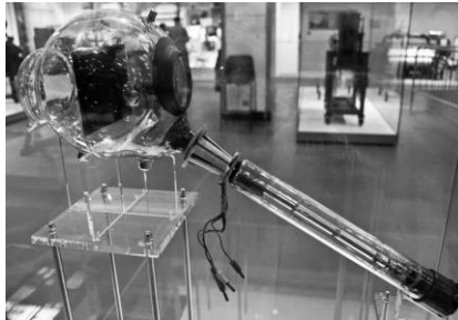
Рис. 2 – Електронно-променева трубка В. Зворикіна
