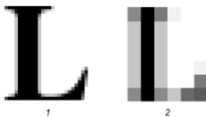
Рис . 3 – Збільшені букви растрового шрифту з застосуванням згладжування для дозволу : 1 - 300 dpi; 2 - 72 dpi
