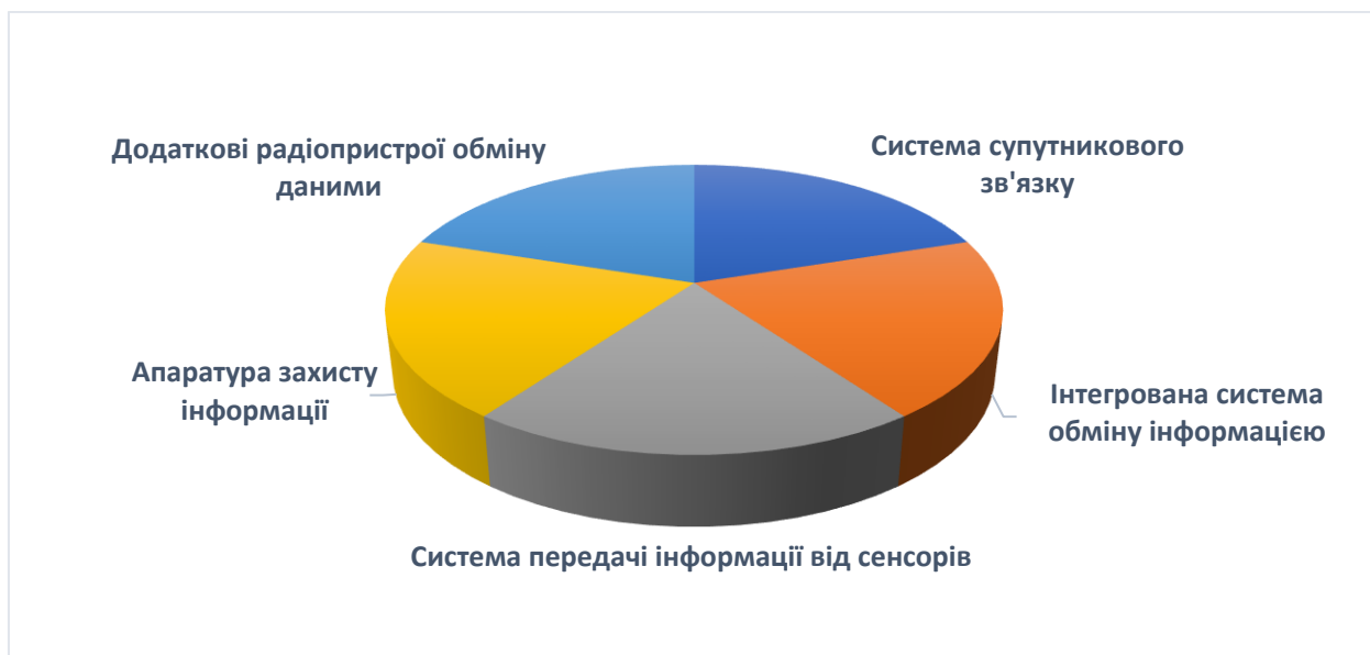
Рисунок 14 - Комплекс зв'язку для БПЛА
