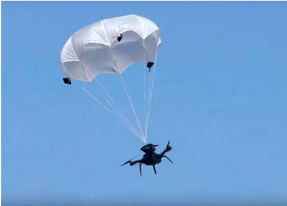
Рисунок 3.4 Парашутна установка на квадрокоптері
