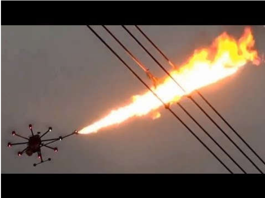
Рисунок 3.5 Октакоптер з вогнеметом, що прибирає сміття з лінії електропередач
