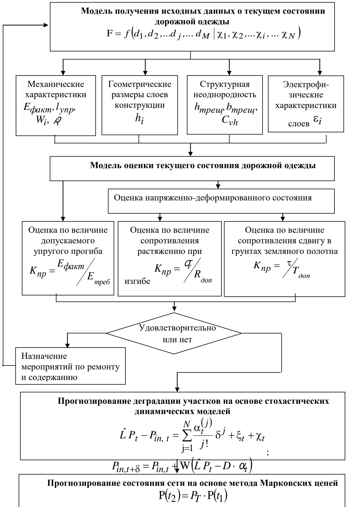
Рис. 1. Комплексная схема оценки и прогнозирования состояния дорожных одежд
