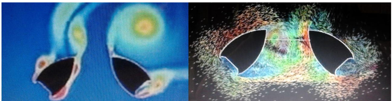
Рис. 4 Напрямок потоку повітря при випробуваннях в аеродинамічній трубці.
