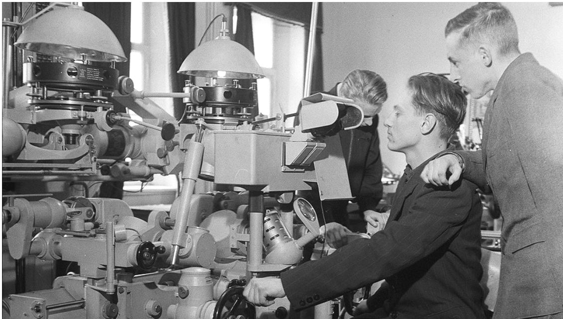
Рис. 10.1. Обробка знімків на стереопланіграфі
